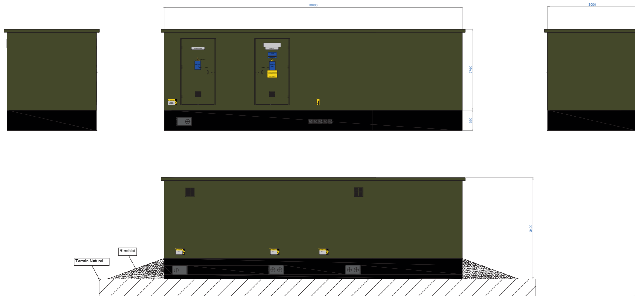
ELEVATIONS DU POSTE DE LIVRAISON - échelle 1/75e
